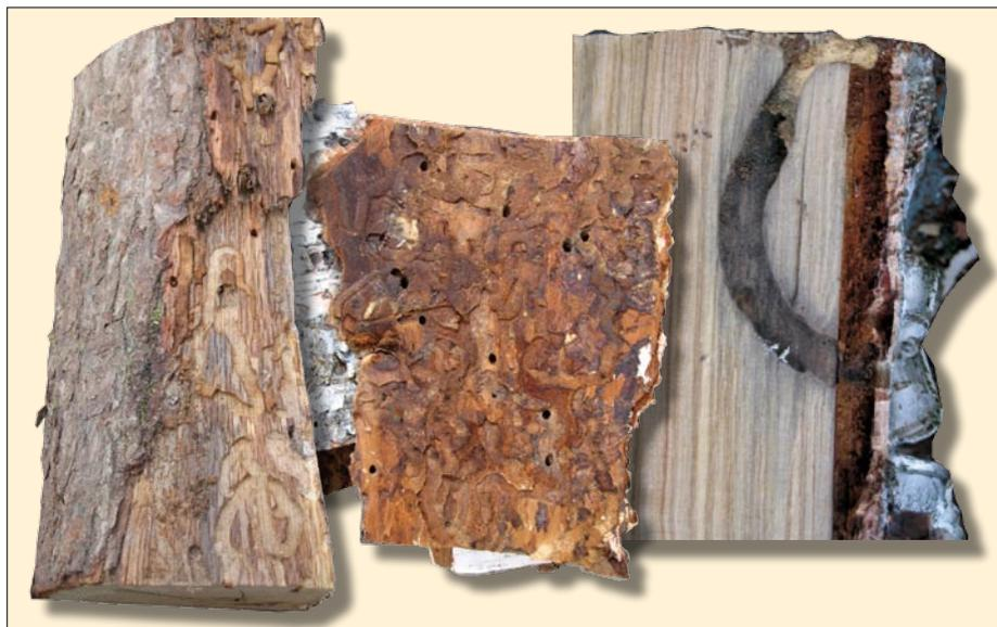
Abb. 1: Bockkäfer-Larvengänge und Ausfluglöcher in der Rinde und im Splint eines Eichenholz-scheites (links), auf der Unterseite von Birkenrinde (Mitte) und Bockkäfer-Hakengang im Splint eines Birkenholz-scheites (rechts)
